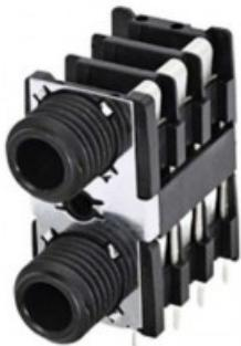
Connettore stereo doppio da 1/4 , naso pieno, vite di montaggio inclusa.Il connettore impilabile da 1/4 presenta la più alta densità di impacchettamento su scheda, in quanto due connettori si trovano in un unico ingombro ed entrano in 1 RU.
