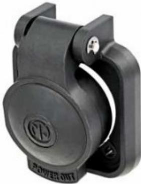
Tappo di tenuta autochiudente FPX per presa PowerCONII tappo di tenuta autochiudente a molla NSSC-2 per prese PowerCON si chiude automaticamente dopo aver scollegato il connettore del cavo e sigilla i connettori dello chassis contro la polvere e l'acqua fino a IP65. Adatto per:NAC3FPX-TOPNAC3FPX-ST-TOPNAC3FPX-WOT-TOP
