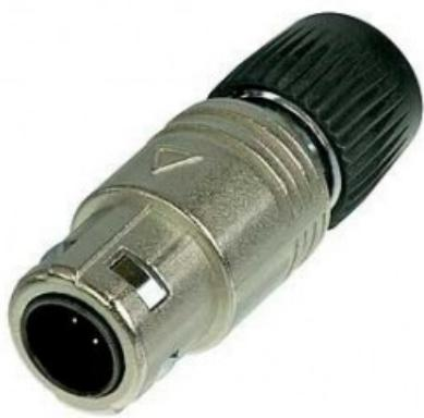
Connettore per cavi maschio a 8 pin, con scarico della trazione, contatti a saldare, codifica a 180°, alloggiamento in nichel. I connettori neutriCON sono progettati per applicazioni industriali/multipin in ambienti difficili ed esigenti. Il connettore circolare in metallo per impieghi gravosi offre un facile assemblaggio senza viti, una combinazione flessibile dei pezzi e un meccanismo di bloccaggio push-pull.
