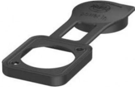
**NUOVO:** Il coperchio di tenuta in gomma di dimensioni D protegge i connettori powerCON TRUE1 TOP NAC3MPX\* e powerCON 20A NAC3MPXXA\* e NAC3MPA-\* dalla polvere e dall'acqua in base alla classe di protezione IP 65. Facile da usare e da assemblare, la sua struttura compatta consente un'elevata densità di imballaggio.
