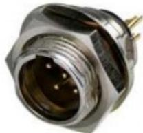
Connettore per telaio TINY xlr maschio a 5 pin per montaggio posteriore (alloggiamento nichelato, contatti dorati, spessore massimo del pannello: 3 mm) Confezionato singolarmente in sacchetto
