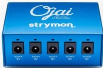
Alimentatore multiplo per pedali effetti 5 uscite ad alta tensione completamente isolate da 9V DC/500mA Include 5 cavi per pedali connettore coassiale da 5,5 mm x 2,1 mm, polarit negativa all'interno, connettore ad angolo retto Include alimentatore e cavo IEC Connnettore di uscita 24VThru che consente il collegamento aggiuntivo a uno Strymon Ojai disponibile separatamente Dimensioni: 81 x 58 x 33 mm Peso: 130 g Prodotto negli Stati Uniti
