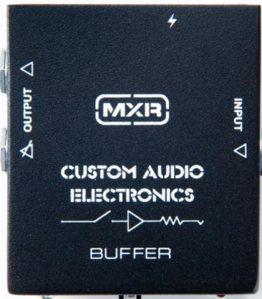
Il CAE Buffer è la soluzione per i problemi che si verificano quando vengono combinati effetti con differenti impedenze. Offre la possibilità di alzare il guadagno di +6dB e regolare la perdita di segnale tramite gli switch Hi-Cut e Low-Cut. Il CAE Buffer ha un'uscita extra per l'accordatore, una catena separata d'effetti o un amplificatore. Una comoda uscita di corrente 9VDC permette di alimentare altri pedali.
