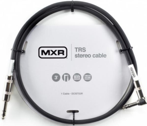
Questi cavi TRS/Stereo sono approvati MXR per un suono pulito e puro. Il conduttore in 24AWG rame oxygen free mantiene l'integrità del suono, mentre la spirale che ricopre il 95% del cablo aiuta a bloccare interferenze involontarie. Il rivestimento in PVC fornisce flessibilità e protezione, mentre i connettori in metallo assicurano una lunga vita on the road.
