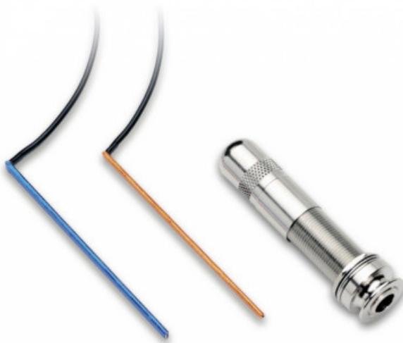
PRO-AG1-125 AG-125 di Fishman è il classico pickup piezo ceramico per chitarra di Fishman, AG-Series non richiede batteria e può essere collegato direttamente all'amplificatore. Le prestazioni dei pickup della serie AG possono essere notevolmente migliorate con l'uso di un preamp per l'adattamento di impedenza come il nostro Platinum Stage, Platinum Pro EQ o Powerjack. AG-125 è il sistema piezoelettrico perfetto per la vostra 6 corde.
