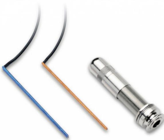
PRO-AGX-312 AGX-312 è il classico pickup piezo ceramico per chitarra di Fishman, AG-Series non richiede batteria e può essere collegato direttamente all'amplificatore. Le prestazioni dei pickup della serie AG possono essere notevolmente migliorate con l'uso di un preamp per l'adattamento di impedenza come il nostro Platinum Stage, Platinum Pro EQ o Powerjack. AGX-312 è il sistema piezoelettrico perfetto per la vostra chitarra classica o a 12 corde.
