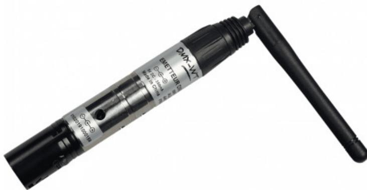
I moduli trasmettitore DMX-WT e ricevitore DMX-WR di Algam Lighting consentono il controllo remoto di un dispositivo o una serie di dispositivi di illuminazione collegando il ricevitore al primo dispositivo della catena. L'abbinamento resta memorizzato nel trasmettitore e nel ricevitore anche dopo l'interruzione della corrente, in modo da semplificare notevolmente l'impostazione di questo sistema. Offrono una trasmissione wireless fino a 512 Canali DMX e un numero illimitato di gruppi.
