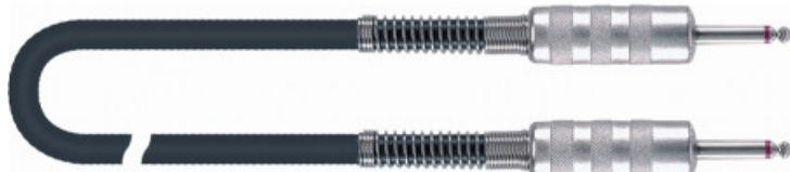
Cavo di potenza Jack /Jack per connessione casse non amplificate, con conduttore di sezione 2x2,5 mm. Utilizza cavo Quik Lok CA/830 (nero) e jumbo Jack mono G/128. Lunghezza: da 5 a 9.5 m m.
