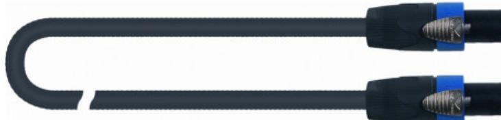
Cavo di connessione per casse amplificate. Realizzato con cavo CA/804 4x2,5 mm (colore nero) e connettori Speakon NS/191 (Neutrik NL4FX). Lunghezza: da 5 a 9.5 m m.
