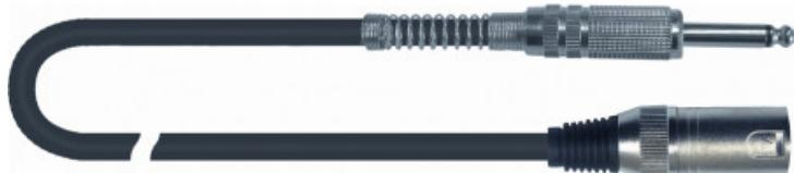
Cavo di potenza Jack /Cannon per connessione casse non amplificate. Utilizza cavo Quik Lok CA/810 2x1 (nero), un connettore Jack mono G/187 ed un XRL maschio NC/355K. A richiesta con connettori Amphenol (G/501AB - NC/535AM) o Neutrik (NC/368 - NC/355). Lunghezza: da 20 a 50 m m.
