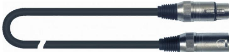
Cavo di potenza Cannon /Cannon per connessione casse non amplificate. Utilizza cavo Quik Lok CA/810 2x1 (nero) e connettori XRL mono NC/354-5K. A richiesta con connettori Amphenol (NC/535AM - NC/534AF) o Neutrik (NC/355 - NC/354). Lunghezza: da 5 a 9.5 m m.
