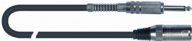
Cavo di potenza Jack /Cannon per connessione casse non amplificate, con conduttore di sezione 2x1,5 mm. Utilizza cavo Quik Lok CA/820, il connettore Jack mono G/187 ed un XRL maschio NC/355K. A richiesta con connettori Amphenol e Neutrik.
