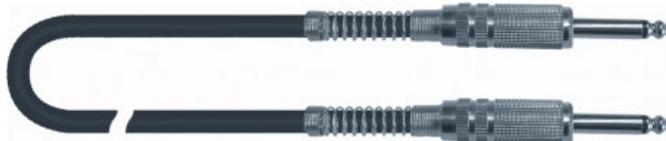
Cavo di potenza Jack /Jack per connessione casse non amplificate, con conduttore di sezione 2x1,5 mm. Utilizza cavo Quik Lok CA/820 (nero) e Jack mono G/187. A richiesta con connettori Amphenol e Neutrik. Lunghezza: 10 m.
