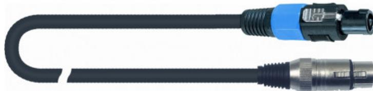
Cavo di connessione per casse amplificate. Realizzato con cavo CA/820 2x1,5 mm (colore nero), connettori Speaker SK391 e XRL femmina NC/354K. Lunghezza: da 5 a 9.5 m m.
