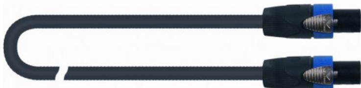
Cavo di connessione per casse amplificate. Realizzato con cavo CA/804 4x2,5 mm (colore nero) e connettori Speakon NS/191 (Neutrik NL4FX). Lunghezza: da 20 a 50 m m.
