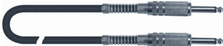
Cavo di potenza Jack /Jack per connessione casse non amplificate, con conduttore di sezione 2x1,5 mm. Utilizza cavo Quik Lok CA/820 (nero) e Jack mono G/187. A richiesta con connettori Amphenol e Neutrik. Lunghezza: da 20 a 50 m m.
