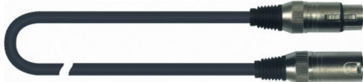
Cavo di collegamento **DMX 512 canali**. Utilizza cavo CM/818 (3 poli 120 ohm) e connettori XLR 3 poli (NC/354K - NC/355K). A richiesta con connettori Neutrik. Lunghezza: 1 m.
