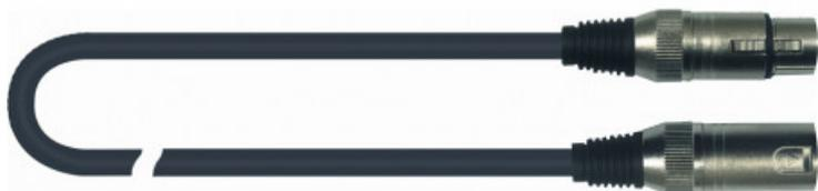
Cavo di collegamento **DMX 512 canali**. Utilizza cavo CM/818 (3 poli 120 ohm) e connettori XLR 3 poli (NC/354K - NC/355K). A richiesta con connettori Neutrik. Lunghezza: 15 m.
