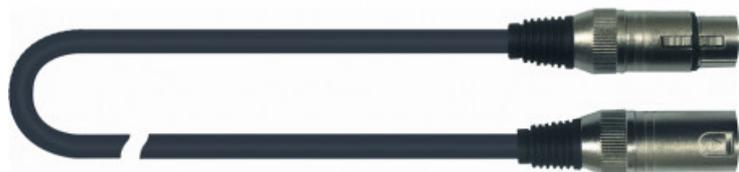
Cavo di collegamento **DMX 512 canali** con 2 segnali di ritorno. Utilizza cavo CMF/832 e connettori XLR 5 poli (NC/348K - NC/349K). A richiesta con connettori Neutrik. Lunghezza: 25 m.
