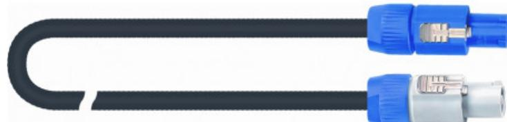
Cavo di alimentazione Array Serie AAR. Utilizza cavo CSF/3015 3x1,5 mm e connettori Powercon® Neutrik. Lunghezza: 0,7 m.
