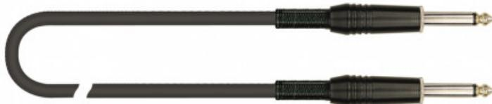
ZJack mono G/458 - Cavo: conduttore 20x0,12 schermo 64x0,2 - Ø esterno 6,00mm - Jack mono G/458
