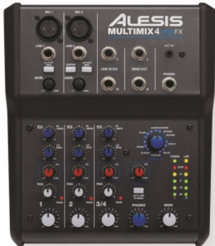
**Mixer 3 canali (2 mono e uno stereo) con eq 2 bande, multi effetto da 8 effetti, con 15 preset, interfaccia audio USB di tipo class compliant (16-bit; 44.1/48 kHz) che aggiunge al computer Mac o PC un ingresso e un'uscita stereo.**
