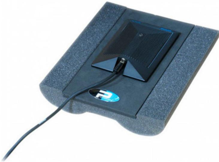
Progettato per i microfoni Boundary" come lo Shure SM91, IL Kickplate isola la risonanza e le vibrazioni della cassa della batteria dai rientri nei microfoni. Comprende uno speciale pad di isolamento e una pesante piastra di metallo che migliora la risposta dei transienti.
