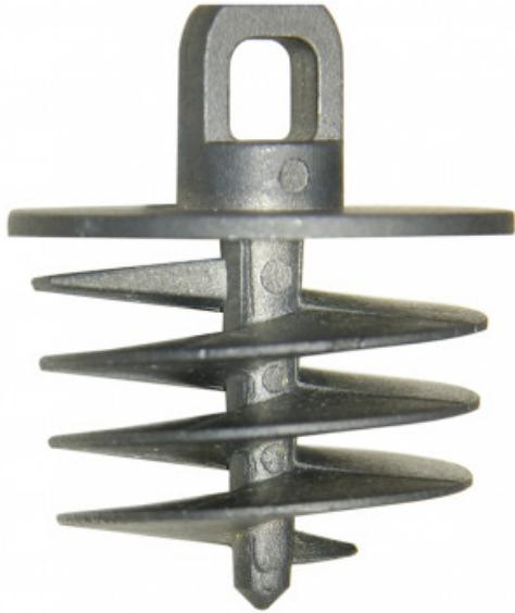
Helix è un solido dispositivo in zinco pressofuso composto da un occhiello ed una vite per un ancoraggio affidabile per appendere qualsiasi pannello Primacoustic in caso di Cloud acustico utilizzando il sistema di regolazione in altezza con il prodotto per la sospensione Slipknot. Confezioni da 12pz.
