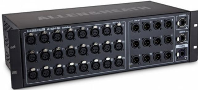
Audio rack (24 XLR IN e 12 XLR OUT). Possibilità di essere collegato fino a 2 expander Mod. AR84 (8 XLR IN, 4 XLR OUT ciascuno) con CAT5 fino a 120 m. utilizzando il protocollo dSNAKE dell'A&H. La dSNAKE fornisce il controllo ai preamp remoti, e tutti i preamps mic sono scene richiamabili. L'AR2412 include inoltre una connessione per sistemi di personal monitoring.
