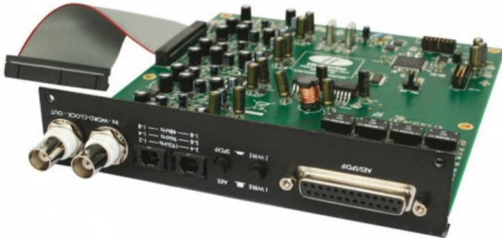
Scheda ADC opzionale (-122dB A-weighted) con **8 Ch** (fino a 192kHz). Sono supportati i formati **AES**, (sia single che dual wire.) **SPDIF**, **ADAT™**, con frequenza di campionamento selezionabile tra **44.1, 48, 88.2, 96, 176.4 e 192kHz**, (per ADAT oltre i 48Khz, naturalmente, tramite 2 porte), word clock interno o esterno e 256X clock, **S/N Ratio migliore di 121dBfs** 'Pesato-A'.
