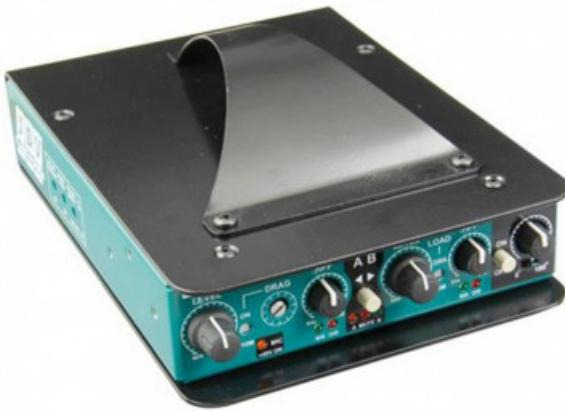
La JDV Mk5™ è una direct box attiva discreta al 100% in classe A che mantiene la topologia di feedback zero negativo originale, ma aggiunge un'incredibile varietà di caratteristiche.
