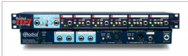
Splitter a Rack con 1 IN e 7 OUT per un sistema di distribuzione di segnali per chitarra.
