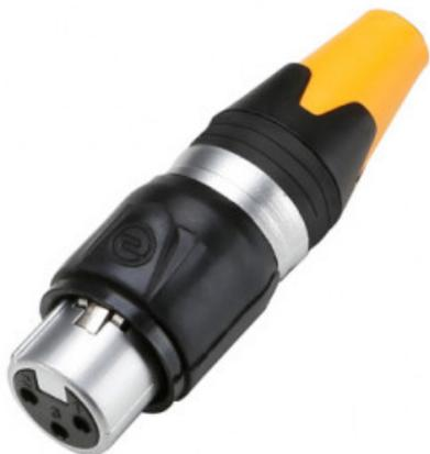
Il 7889 è un connettore XLR a 3 pin femmina di alta gamma con protezione IP65 per uso all'esterno. È protetto dall'entrata di acqua e di polvere quando viene associato al telaio e ai connettori per cavi adeguati' compatibile con cavi fino a 8 mm di diametro. Il connettore XLR è caratterizzato da un resistente involucro di zinco pressofuso e da contatti da saldare dorati.
