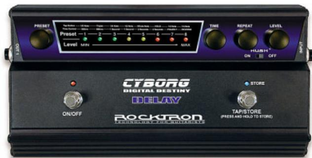
8 tipi di Delay (500 ms per 32 secondi più reverse) di alta qualità. Time control, Repeat, Level. Footswitch 1: On/Off Effetto "On" o Bypassato. Footswitch 2: Tap/Store, premendo per 2 secondi si memorizza, 8 presets. MIDI IN/ MIDI OUT/THRU, è possibile memorizzare i preset del pedale nelle padaliere MIDI. 28 presets programmabili con il pedale utilizzato con pedaliera MIDI. Hush Noise Reduction incluso
