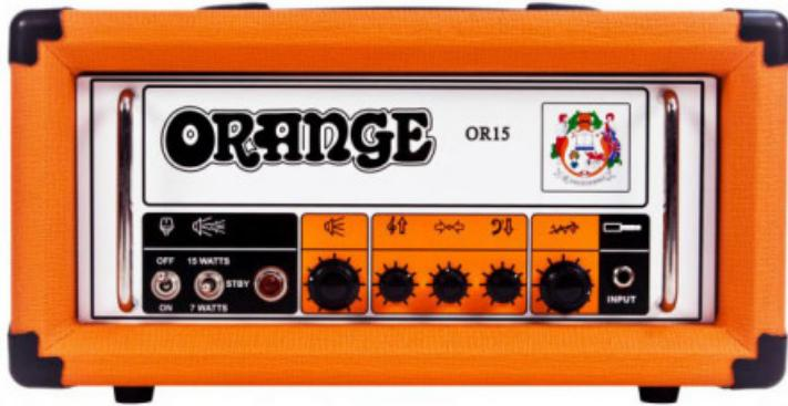
Testata per chitarra elettrica a Valvole. 15w. 1 canale. Potenza selezionabile 15w/7w. Comandi: Equalizzatore alti, medi e bassi, Volume e Guadagno. Loop di effetti con valvola ECC81/12AT7. Design "Pics Only". Valvole: 3x ECC83/12AX7 preamplificatore, 2x EL34 di potenza. Uscite altoparlante: 1x16ohm, 1x8ohm, 2x16ohm. Dimensioni: 40 x 40 x 18 cm. Peso: 8Kg aprox. Classic rock tones.
