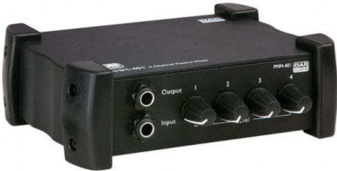
Il PMM-401 è un mixer passivo a quattro canali per consentire l'espansione di un mixer con segnali di linea extra. Non richiede batterie o altra sorgente di alimentazione. Quando tutti i controlli sono girati completamente in senso orario, l'unità può essere utilizzata come scatola con 1 entrata e 4 uscite. Si tratta di uno strumento utile che vi aiuterà nelle situazioni impreviste.
