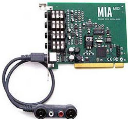
Echo MiaMIDI è una scheda audio PCI potente e versatile con 2 In e 2 Out analogici, un ingresso e un'uscita SPDIF e connessioni MIDI.
