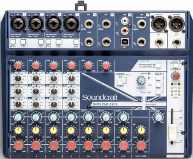
MIXER ANALOGICO USB 12 CANALI, 4 MIC INPUT, ALIMENTAZIONE PHANTOM, EFFETTI DIGITALI
