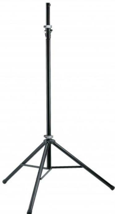
Facile da trasportare, supporto per illuminazione in alluminio leggero, prolunga con adattatore per prendere un perno TV (tubo di prolunga interno diametro 28 mm). Costruzione stabile del treppiede. Regolabile in altezza con comode leve di bloccaggio e perno di sicurezza aggiuntivo. - Max. central load capacity: 20 kg. Extension tube diametro 35 mm. Peso: 2.7 kg, H: 1800/3220 mm.
