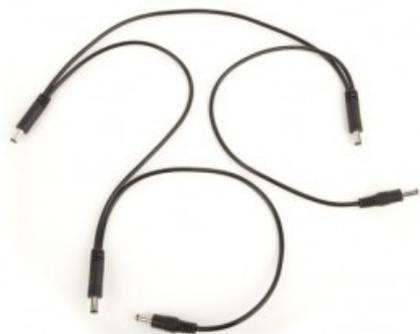
Cavo di alimentazione multi-uscita robusto ed affidabile per alimentare contemporaneamente più pedali analogici che non richiedano un'uscita esclusiva isolata. Collegandolo ad una uscita singola dell'Ojai o Zuma alimenta fino a 4 pedali. Connettori: 2.1mm dritto (5) Polarità: Standard (negativo al centro) Lunghezza: 48" (122cm) Distanza tra i connettori: 12" (30cm)
