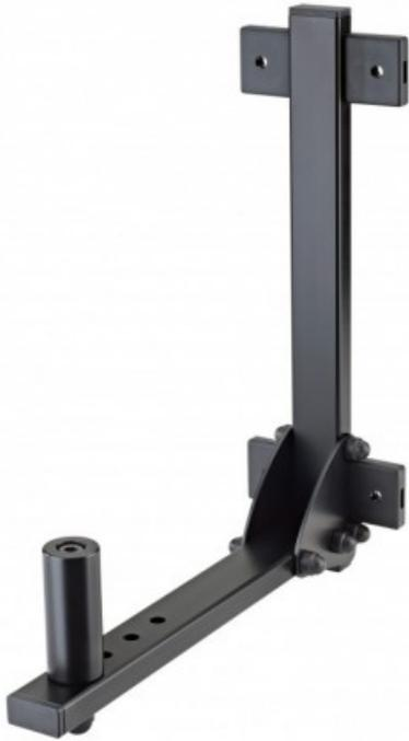
Supporto da parete per casse acustiche con montaggio a flangia da 36 mm. Questo design nasconde in gran parte il montaggio a parete con la scatola degli altoparlanti. Design molto forte e robusto, destinato a max. carico di 35 kg. La distanza degli altoparlanti dalla parete può essere regolata individualmente in 4 posizioni. - GS-approved for loads up to 35 kg . Peso: 2.6 kg, H: 410 mm, wall-to-bolt clearance 225/255/285/315 mm.
