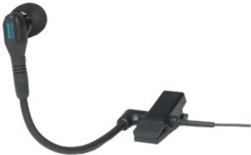
Il microfono Shure WB98H/C (versione wireless del BETA98H/C) è un cardioide a condensatore per strumenti, che si può fissare al bordo del fusto di un tamburo (rullante, tom) oppure sull'apertura di uno strumento a fiato. Il collo d'oca snodabile da 12cm integrato permette al microfono di essere posizionato e assicurato correttamente allo strumento, mentre lo shock-mount riduce i rumori meccanici. Cavo da 1,6m con connettore TA4F per connessione a bodyspace. Astuccio di protezione con cerniera.
