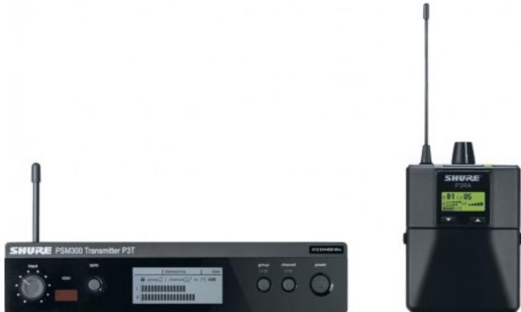
Set composto da un trasmettitore P3TE e un ricevitore premium P3RA. Fornito con kit di montaggio rack singolo/doppio, antenna 1/4 d'onda e alimentatore esterno. Batteria SB900A disponibile a parte come optional. Gamma di frequenza wireless L19: dai 630 ai 654 MHz.
