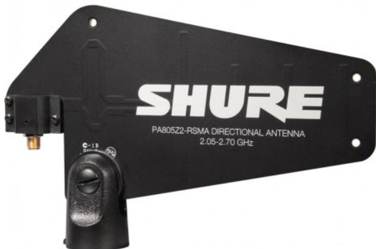
L'antenna direzionale passiva PA805Z2-RSMA è un componente fondamentale del sistema GLX-D. Questi dispositivi possono sia migliorare la ricezione dei trasmettitori, sia ridurre le interferenze di altre fonti a 2.4GHz. Include cavo RSMA da 3,05m.
