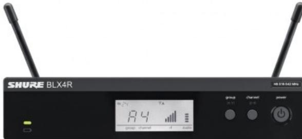
Ricevitore analogico wireless per installazione a rack (kit incluso) con doppia antenna integrata, 150 frequenze selezionabili, max 12 sistemi in contemporanea sulla stessa banda, dotato di uscita bilanciata su XLR (-27 dBV) e sbilanciata su Jack da 1/4" (-13 dBV) compatibile con le serie wireless PG, SM e Beta. Ricerca automatica dei canali disponibili. Alimentazione 12-15 V DC @ 260 mA. Dimensioni e peso: 40x188x103mm; 241grammi. Gamma di frequenze wireless M17: dai 662 ai 686 MHz.
