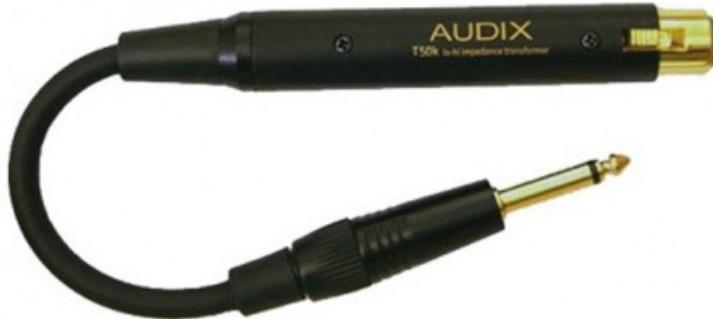
Trasformatore di corrispondenza ad impedenza professionale che consente di collegare un microfono abassa impedenza (100-600 Ohm) ad un ingresso ad alta impedenza (10k - 50k Ohm).
