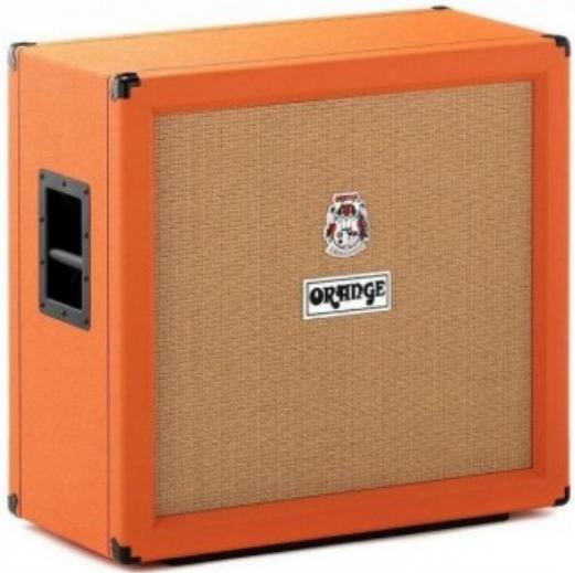
Cassa acustica per amplificatore per chitarra. 240w / 16 ohms. 4x altoparlanti Celestion Vintage 30. 2x ingressi Jack 1/4" in parallelo. Piedi antiscivolo. Dimensioni: 78 x 74 x 37 cm. Peso: 46 kg. PPC: Power Projection Cabinet. Compensato di betulla a 13 strati da 18 mm. Struttura resistente.
