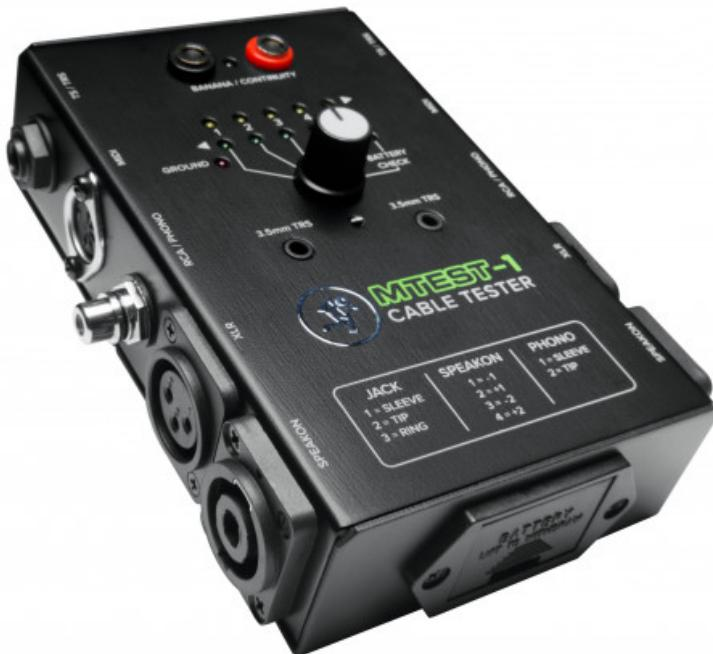
Non rischiare mai più con i tuoi cavi. MTEST-1, alimentato a batterie, è uno strumento per testare i cavi, dotato di uno switch a 5-vie per testare ogni pin. Consente di effettuare test manuali grazie alle sonde incluse. Equipaggiato con i più usati connettori inclusi TRS, TS, XLR, RCA, Speakon, 3,5mm TRS, MIDI e Banana.
