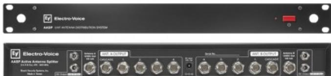
Distributore d'antenna attivo 2-in x 8-out. Distribuisce l'alimentazione CC per un massimo di 4 ricevitori. Distribuisce due antenne per un massimo di 4 ricevitori diversity. Uscita in cascata per collegare più distributori senza perdere le uscite. Per impostazione predefinita, offre un'alimentazione a 12 V CC per i booster o le antenne attive (attivabile o disattivabile dall'interno dello chassis mediante un interruttore). Frequenza di lavoro 470 - 960 MHz
