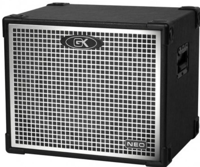
Neo115-III Diffusore per basso 2 vie, 400W su 8 Ohm, uno speaker Paragon 15"• in neodimio, tromba Paragon per le alte frequenze, crossover passivo con limiter sulla tromba, connessioni jack e speakon, selettore per la bi-amplificazione. Dimensioni cm 60,2 x 49,9 x 47,4. Peso 18,1 Kg.
